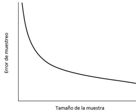
Figura 1. Comportamiento del error de muestreo al crecer el tamaño de la muestra
