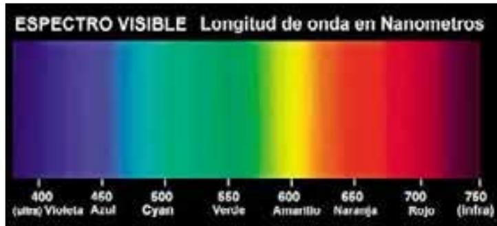
Fig. 13. Espectro de las frecuencias visibles.
